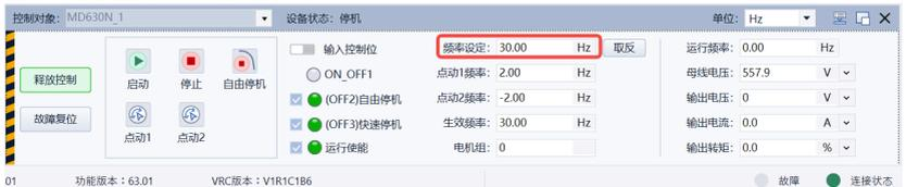
3. 停机状态下，点击“启动”按钮，即可使电机按照第2步设定的频率转动。
