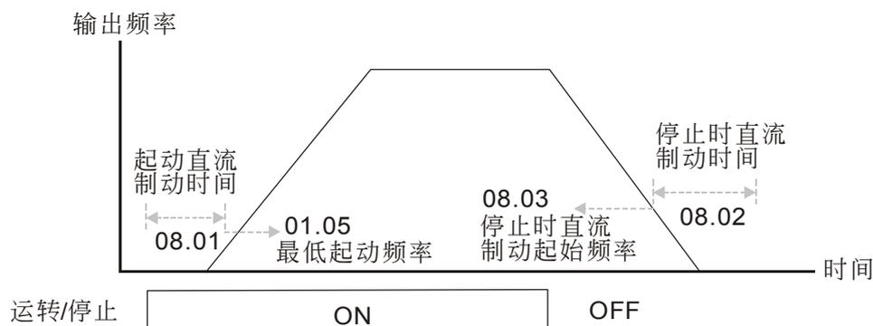
直流制动输出时序图
