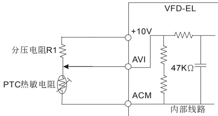
范例：以标准 PTC 电阻为例保护准位=1330Ω，+10V-ACM 实际量测值=10.5V，分压电阻 R1=4.4KΩ。
