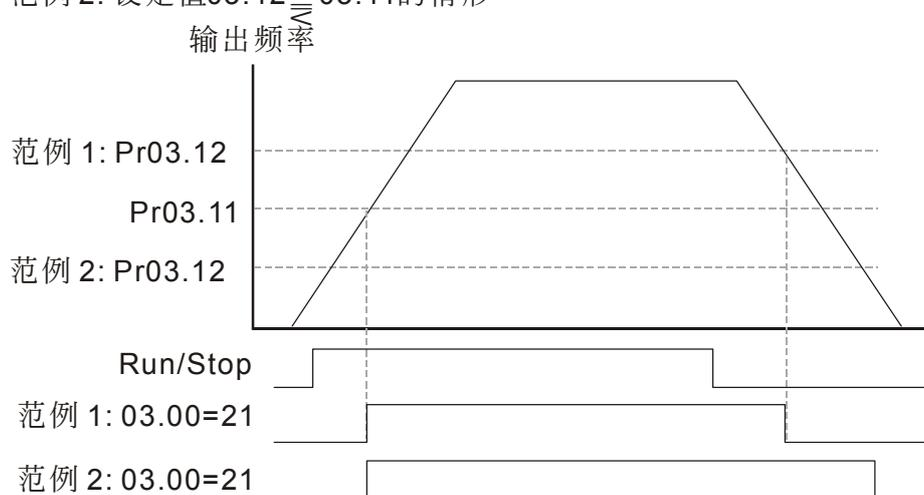
参数 03.00 多功能输出端子选项『21：机械煞车控制』：当输出频率到达参数 03.11 机械煞车释放频率时，此多功能输出端子闭合 (导通)；当输出频率到达参数 03.12 机械煞车动作频率时，此多功能输出端子断路。
