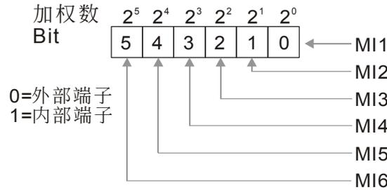
设定方法：内部端子的设定是以二进位 12bit 的方式设定再转成 10 进位的值，才可输入本参数。
