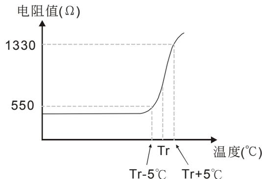
当电机温度过热保护准位为 1330Ω时，参数 07.14 设定为 2.4，计算如下：
