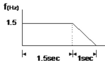
故停止命令動作後馬達所行走的距離 = 旋轉圈數  $\times$  圓周長 =  $1.5 \times 2\pi r$ ，
