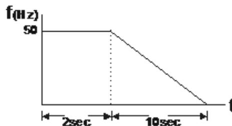
故停止命令動作後馬達所行走的距離 = 旋轉圈數  $\times$  圓周長 =  $175 \times 2\pi r$ ，也就是說轉盤轉了 175 圈後回到頂端。
