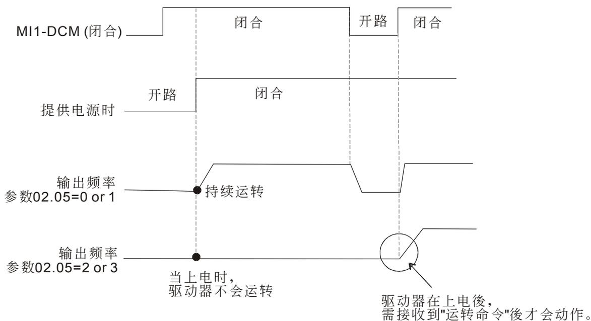
当此参数的功能设定 1, 3 时，驱动器不能保证绝对不会运转。因可能受到机械的震动或开关零件的不良导致产生开关的弹跳现象而造成运转，使用此功能时务必小心。
