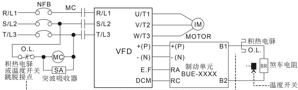
■ 当交流电机驱动器有加装直流电抗器 (DC Reactor)时, 其煞车模块之电源输入回路
